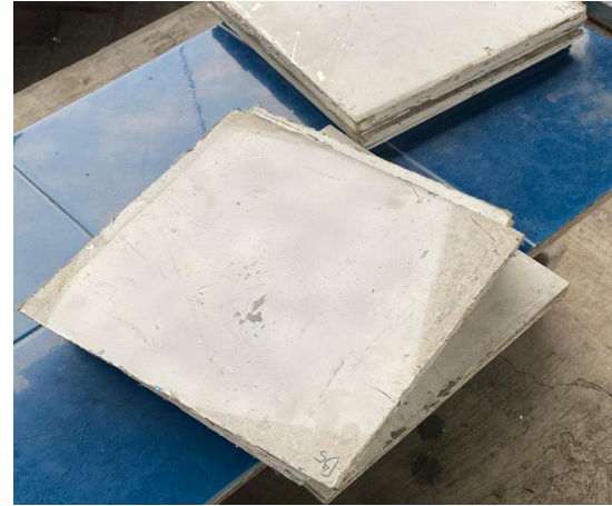
Gambar2.8 ACP telah dilapisi cat tahan api
