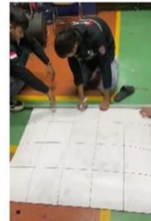
Gambar 2.3 Fabrikasi pengukuran dan pemotongan material PTFE/Teflon
