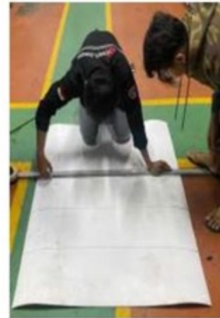
Gambar 2.3 Fabrikasi pengukuran dan pemotongan material PTFE/Teflon
