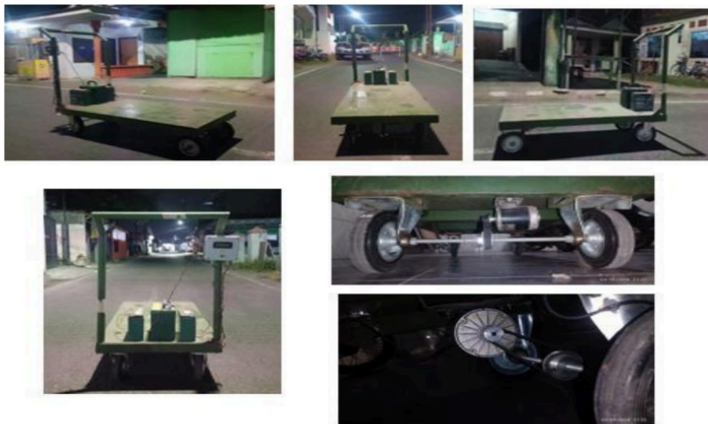
Gambar 3.1 Realisasi Troli Barang elektrik Berbasis Motor DC
