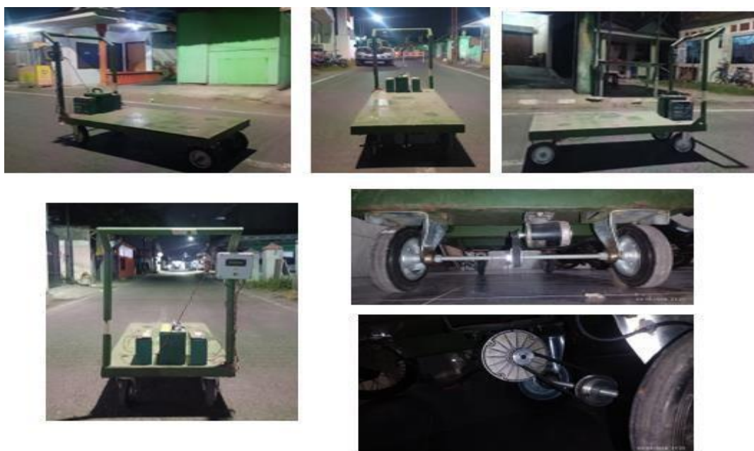
Gambar 3.1 Realisasi Troli Barang elektrik Berbasis Motor DC
