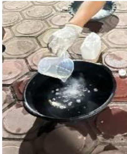
Gambar 5. Proses pencampuran slag aluminium dengan \text{H}_2\text{SO}_4 10%
