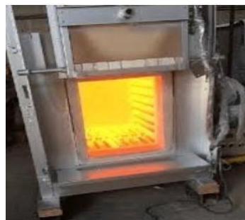
Gambar 2.10 (a) Sampel ACP dengan material inti POM saat uji suhu tinggi (b) Furnace/Tungku untuk uji suhu tinggi
