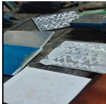
Gambar 2.4 (a) Mengukur dan memotong lembar aluminium 5052 dan POM (b) Melengketkan ACP dengan lem aluminium N 193 (c) Pengepresan agar lengketnya lebih kuat selama 45 menit
