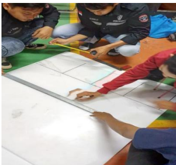
Gambar 2.4 (a) Mengukur dan memotong lembar aluminium 5052 dan POM (b) Melengketkan ACP dengan lem aluminium N 193 (c) Pengepresan agar lengketnya lebih kuat selama 45 menit
