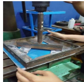
Gambar 2.4 (a) Mengukur dan memotong lembar aluminium 5052 dan POM (b) Melengketkan ACP dengan lem aluminium N 193 (c) Pengepresan agar lengketnya lebih kuat selama 45 menit
