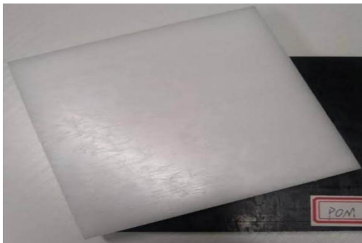
Gambar 2.3 (a) Lembar material Polyoxymethylene (POM) (b) Skema pemotongan lembar POM
