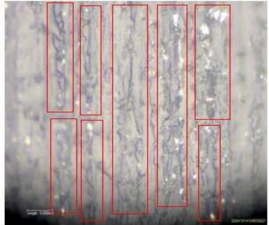
Gambar 3.1 (a) Pengamatan mikrostruktur/struktur mikro ACP dengan material inti POM sebelum uji suhu tinggi menggunakan Mikroskop Optik (MO) perbesaran 1000x. (b) Pengamatan mikrostruktur/struktur mikro ACP dengan material inti POM sesudah uji suhu tinggi menggunakan Mikroskop Optik (MO) perbesaran 1000x.
