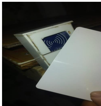
Gambar 5. Kartu RFID ditempelkan pada sensor
