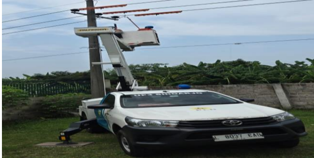
Gambar 2. Proses Pemeliharaan Jaringan Menggunakan Skylift
