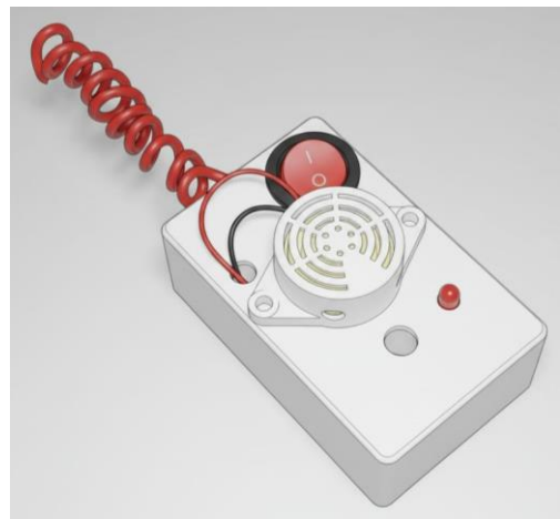
Gambar 10. Perangkat Sistem Early Warning Deteksi Tegangan 20 kV
