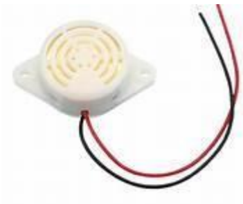
Gambar 3. Komponen Buzzer pada Sistem Early Warning
