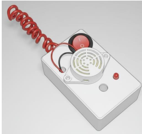
Gambar 10. Perangkat Sistem Early Warning Deteksi Tegangan 20 kV
