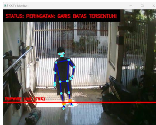
Gambar 4 Sampel Hasil Tangkapan Layar Deteksi Human Landmark dan Batas Virtual saat Uji Coba.
