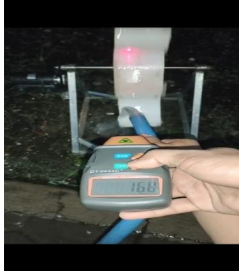
Gambar 5. Pengujian aktual dengan tachometer
