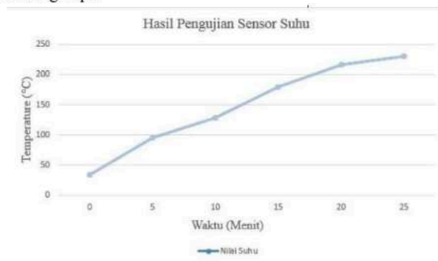
Gambar 5. Grafik Hasil Pengujian Sensor Suhu Pada Proses Roasting
