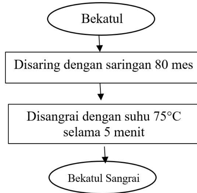
Gambar 1. Diagram Alir Proses Sangrai Bekatul (Modifikasi)
