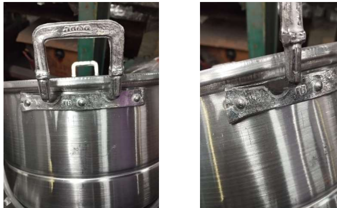
Gambar 5 Uji Coba Tekanan 300 psi
