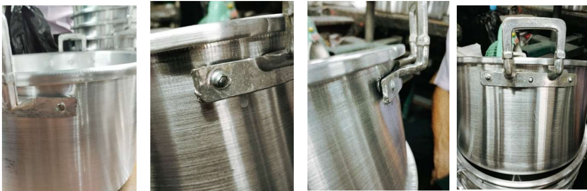
Gambar 3 Uji Coba Tekanan 245 psi
