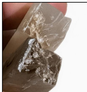
Gambar 17. Patahan uji impact variasi penambahan amilum 0% dengan 5%
