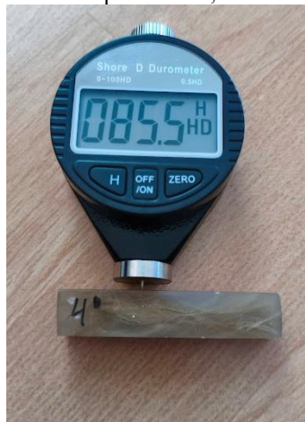
Gambar 20. Pengujian spesimen Kekerasan shore D
