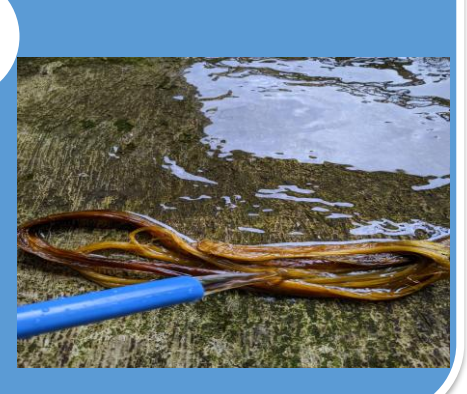
Pencucian dan pembersihan serat kenaf untuk menghilangkan sisa lendir dan kotoran
