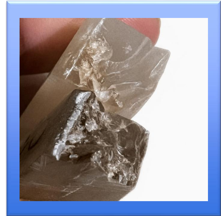
Patahan uji impact
