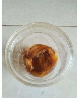
Gambar 12. Proses Perlakuan Alkali Atau Proses Perendaman Serat Kenaf
