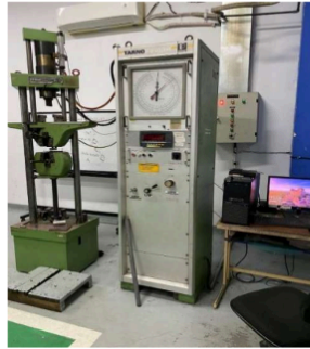
Gambar 11. Alat Uji Tarik Dan Uji Bending
