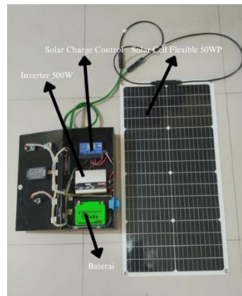
Gambar 5. Tampak Dalam Prototipe Panel Surya Untuk Pendakian
