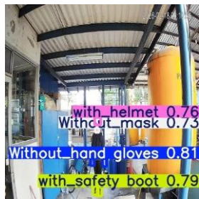
Gambar 13. Bahan 7 sebagai evaluasi model Gambar 13 kondisi operasional standar dengan pencahayaan optimal, jarak ideal, dan posisi pekerja yang terbuka. Pemilihan citra ini berfungsi sebagai parameter kontrol ( baseline ) untuk membuktikan bahwa model dapat mencapai akurasi deteksi maksimal pada situasi yang minim gangguan visual.
