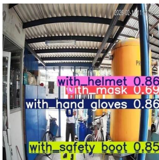
Gambar 7. Bahan 1 sebagai evaluasi model Pemilihan gambar 7 bertujuan untuk mengevaluasi performa model terhadap objek yang berada pada jarak pantau maksimal dari kamera CCTV. Kondisi ini menuntut ketajaman model dalam mengenali fitur Alat Pelindung Diri berukuran sangat kecil (minim piksel) tanpa kehilangan tingkat keyakinan ( confidence score ).
