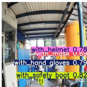
Gambar 15. Bahan 9 sebagai evaluasi model Gambar 15, model dituntut untuk mampu memisahkan bounding box masing-masing individu tanpa menggabungkannya menjadi satu deteksi yang salah.
