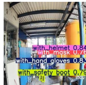
Gambar 14. Bahan 8 sebagai evaluasi model Gambar 14 ini memuat tantangan ambiguitas visual yang tinggi, seperti keberadaan benda (topi putih di tangan pekerja) yang memiliki karakteristik bentuk dan warna menyerupai kelas masker, guna menguji tingkat presisi ( False Positive ) dari model.
