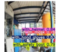
Gambar 14. Bahan 8 sebagai evaluasi model Gambar 14 ini memuat tantangan ambiguitas visual yang tinggi, seperti keberadaan benda (topi putih di tangan pekerja) yang memiliki karakteristik bentuk dan warna menyerupai kelas masker, guna menguji tingkat presisi ( False Positive ) dari model.
