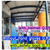
Gambar 12. Bahan 6 sebagai evaluasi model Gambar 12 untuk menganalisis hasil deteksi pada objek pekerja yang berada di sudut ekstrem atau tepian bingkai ( frame ) kamera CCTV. Pada area ini, objek sering kali mengalami distorsi visual.
