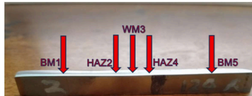
Gambar 7. Posisi Pengujian Kekerasan Vickers Spesimen 8
