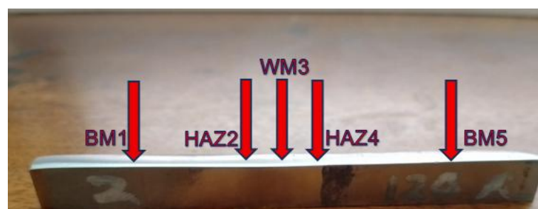
Gambar 7. Posisi Pengujian Kekerasan Vickers Spesimen 8
