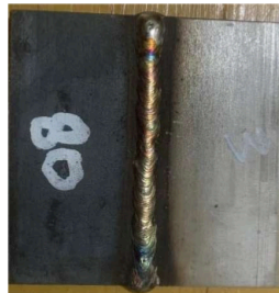
Gambar 16. Hasil Terbaik Pengujian Makrostruktur
