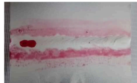
Gambar 15. Hasil Terburuk Pengujian Liquid Penetrant
