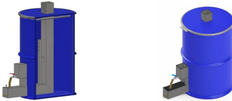
Gambar 9 Gambar Desain Baru alat pembuatan arang batok kelapa
