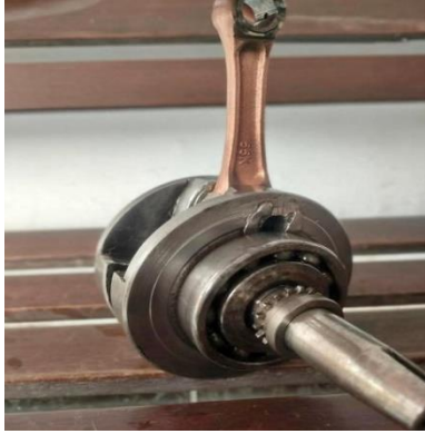
Gambar 5. Askruk dengan stroke 73 mm
