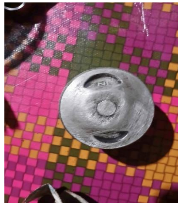
Gambar 2. Askruk dengan stroke 73 mm
