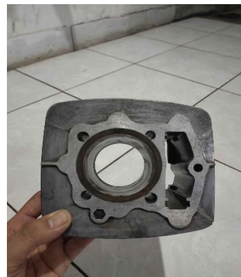
Gambar 4. Diameter standar 63,5 mm dan diameter luar 69,5mm
