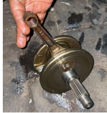
Gambar 6. Askruk dengan stroke 49,5 mm
