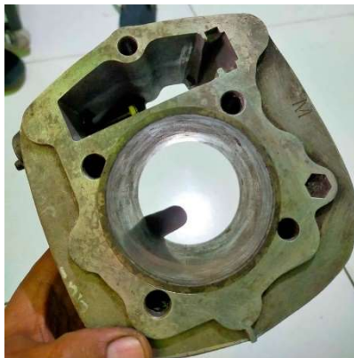
Gambar 3. Silinder berdiameter dalam 68 mm dan diameter luar 74mm
