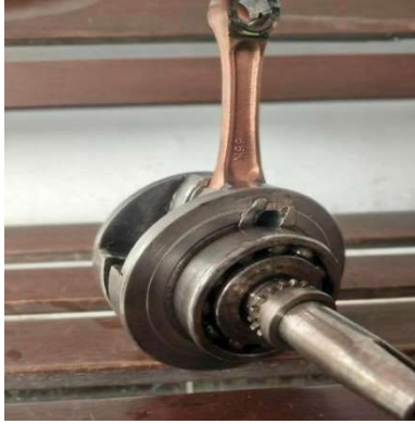
Gambar 5. Askruk dengan stroke 73 mm
