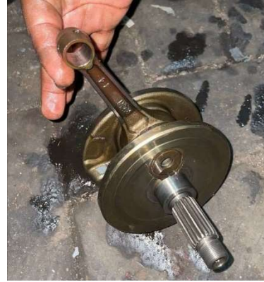
Gambar 6. Askruk dengan stroke 49,5 mm
