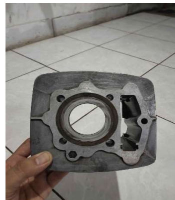
Gambar 4. Diameter standar 63,5 mm dan diameter luar 69,5mm
