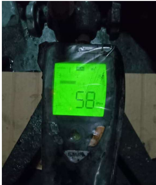
Gambar 10. Hasil pengamatan visual kekentalan alginate pada variasi waktu pengadukan menggunakan viscometer Pengujian ini bertujuan untuk mengetahui pengaruh variasi durasi waktu pengadukan terhadap nilai viskositas alginate yang dihasilkan, serta membandingkan hasil pencampuran antara sistem kontrol konvensional dan sistem berbasis Arduino dan Nextion Display.
