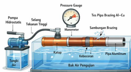
Gambar 3. Ilustrasi Uji Hidrostatis
