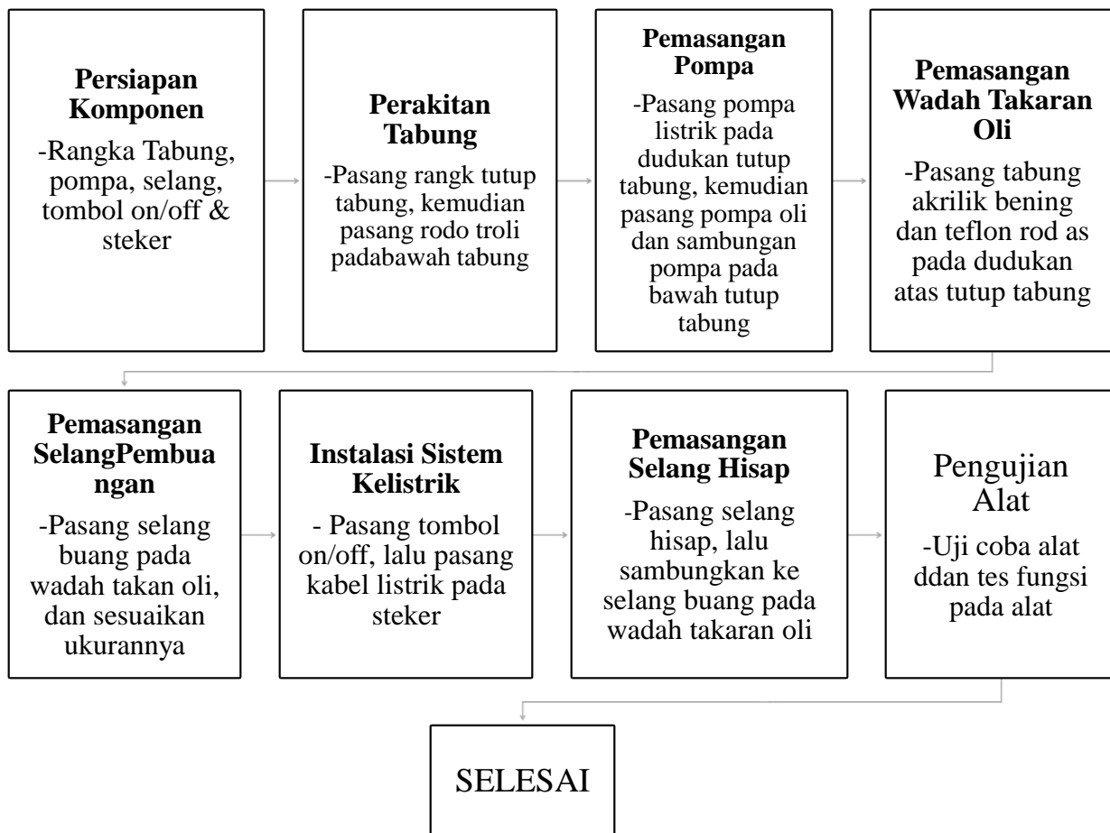
Gambar 7. Diagram Proses Pembuatan Dan Perakitan
