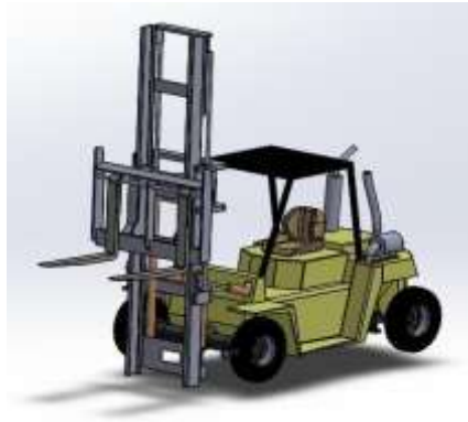
Gambar 2. Desain mesin forklift 5 ton
