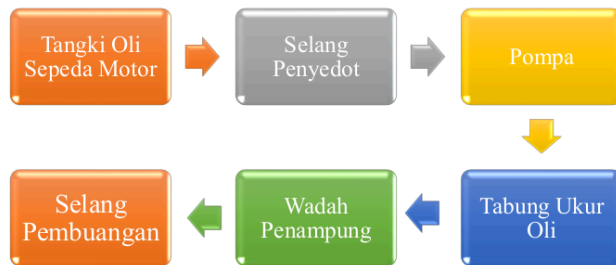
Gambar 2. Prinsip Kerja Alat Penyedot Oli
