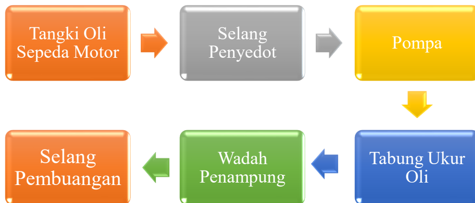
Gambar 2. Prinsip Kerja Alat Penyedot Oli
