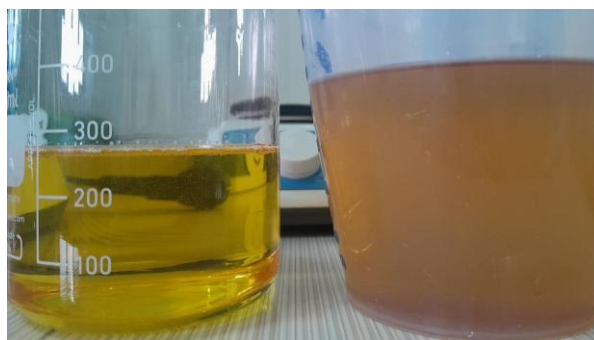
Gambar 3. Perbedaan minyak jelantah setelah dan sebelum mikrofiltrasi
