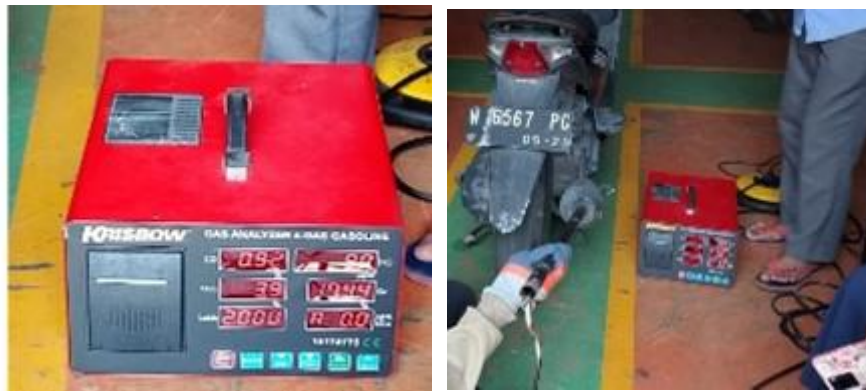
Gambar 3. Pengujian Peralatan Pabrik pada Emisi Gas Buang Kendaraan
