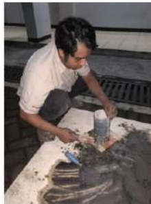
Gambar 3. 17 Pengadukan Benda Uji
