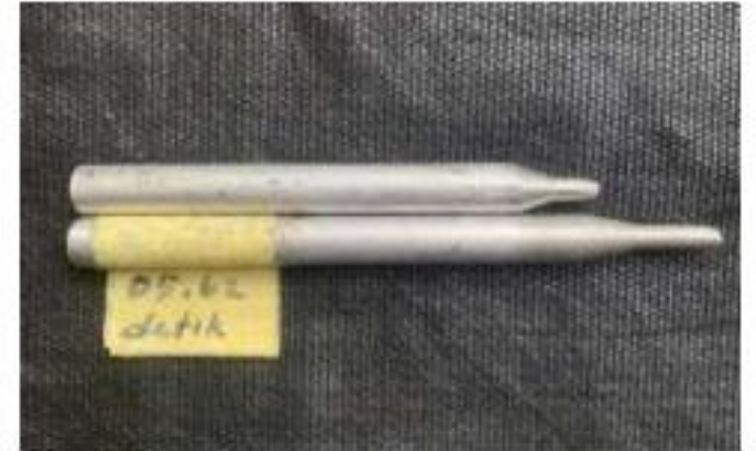
Spesimen Sesudah di Uji Tarik
