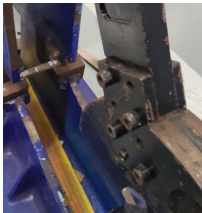
Gambar 13. Pengujian Kekuatan Impak
