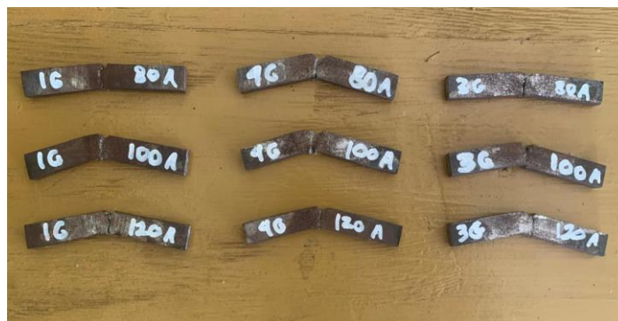
Gambar 18. Hasil Pengujian Impak Pengelasan 1G, 3G dan 4G SMAW ( Shielded Metal Arc Welding )
