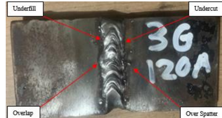
Spesimen 8 (120 Ampere posisi pengelasan 3G)
