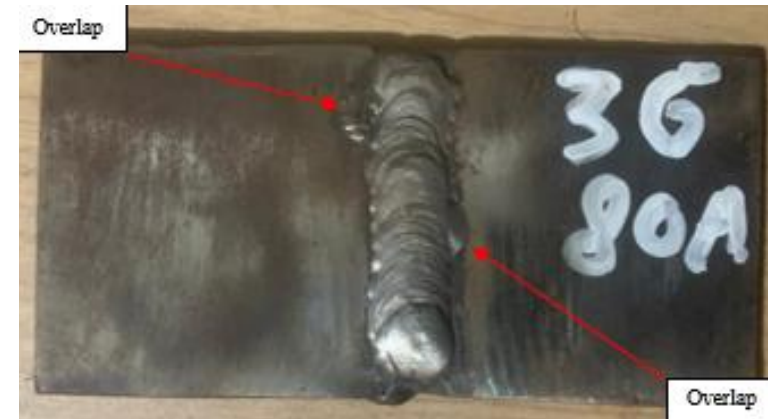
Spesimen 2 (80 Ampere posisi pengelasan 3G)
