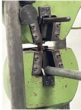
Gambar 6. Pengujian Tarik Pada Spesimen
