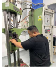
Gambar 5. Pengujian Tarik Pada Spesimen
