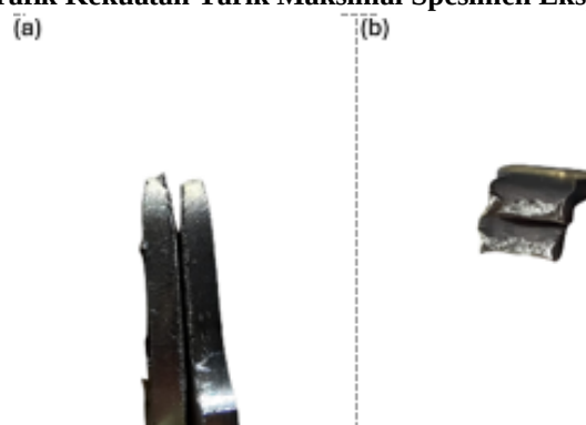
Gambar 3.5 Hasil uji tarik maksimal Spc 1 R3 eksperimen (a)tampak samping, (b) tampak patahan
