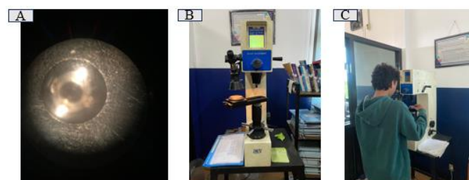
Gambar 7. A) Luka Hasil Uji Kekerasan, B) Alat Uji Kekerasan, Proses Uji Kekerasan
